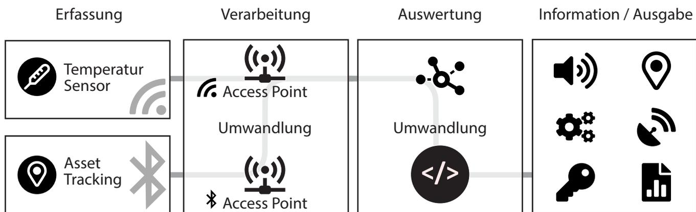
*technischer Ablauf von der Aufnahme der Signale bis zur Ausgabe von Warnungen bzw. Prozessschritten*
